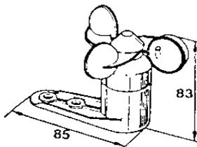
**1 capteur de vent** (anémomètre) qui mesure la vitesse.
